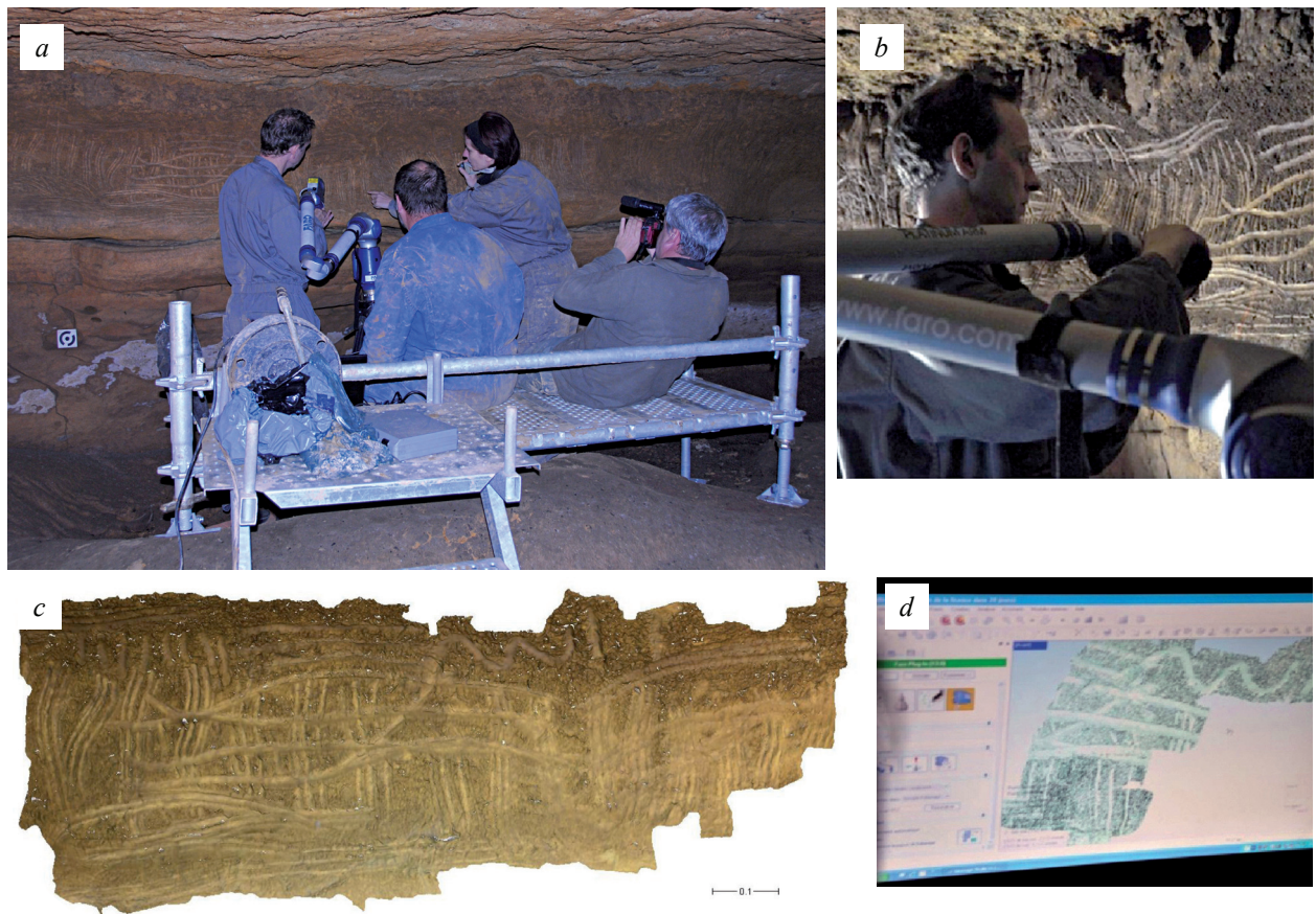
Figure 3 - Test de numérisation d'un panneau orné du secteur 13 par le scanner laser Scan Arm (FARO) ; a) Mise en place du ScanArm ; b) numérisation du grand panneau orné du secteur 13 ; c) modèle numérique du panneau (maillage fin) ; d) visualisation en temps réel des nuages de points.
