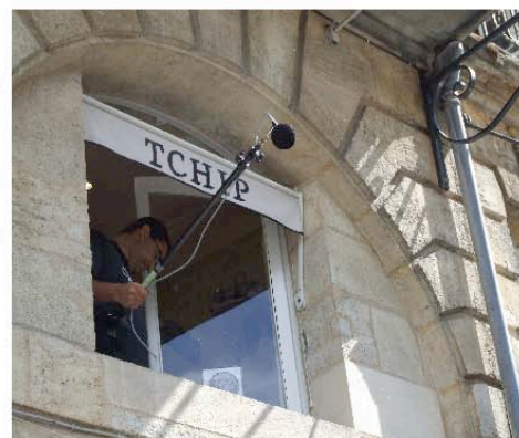
Figure 37. Mise en place du micro du sonomètre devant la façade
