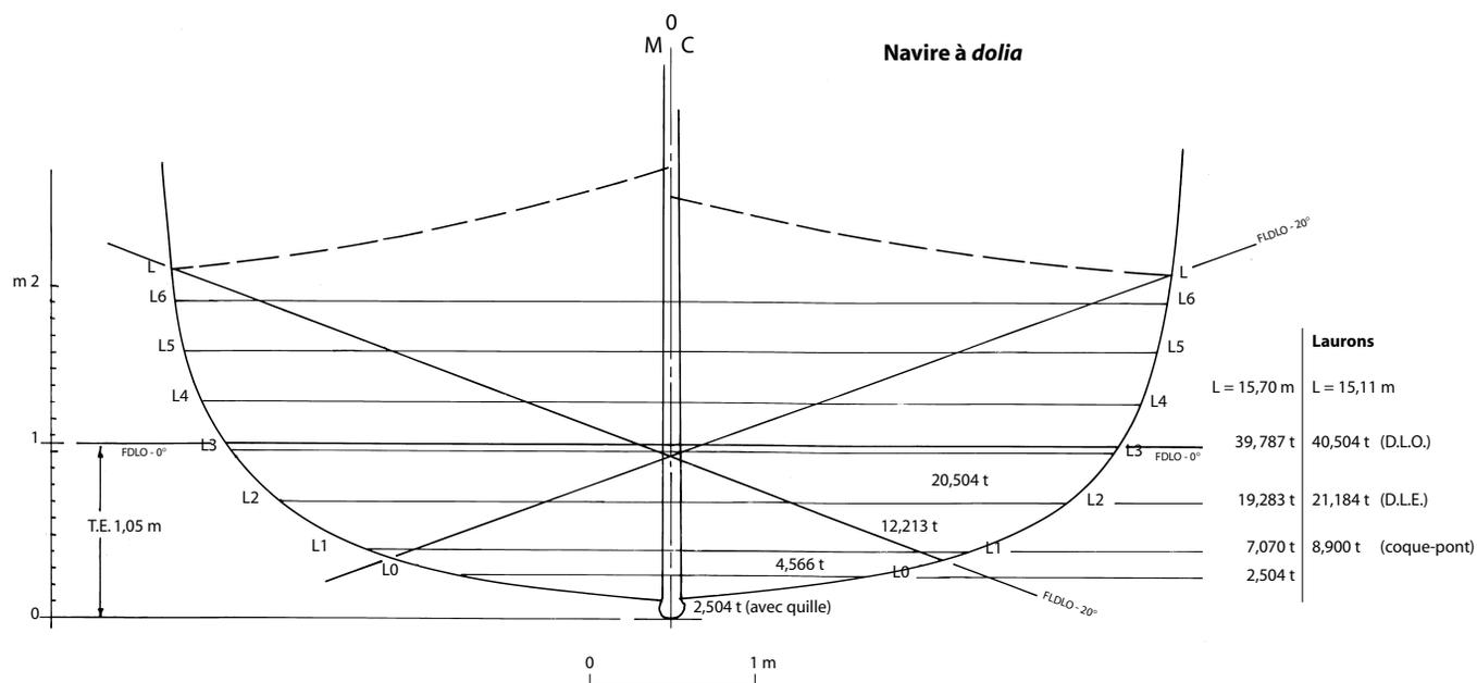
Fig. 16: Schéma de la méthode graphique de calcul de déplacement (dessin R. Roman, CCJ, CNRS, Aix-en-Provence).
