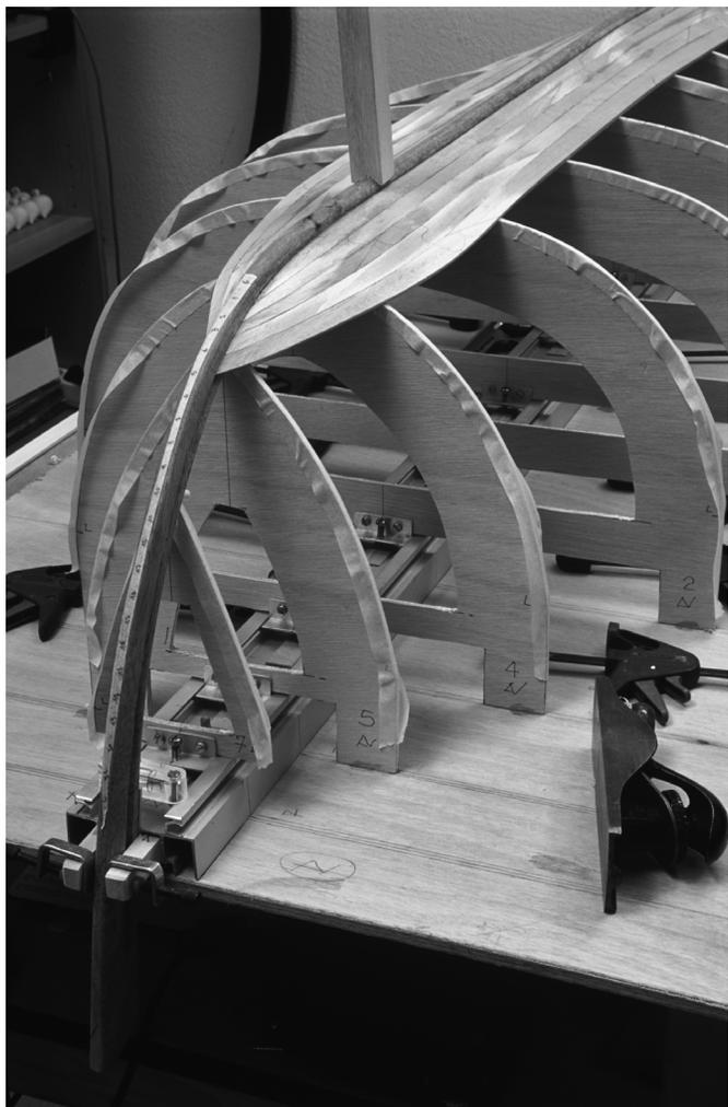
**Fig. 3 :** Construction de la maquette : mise en place du bordé
