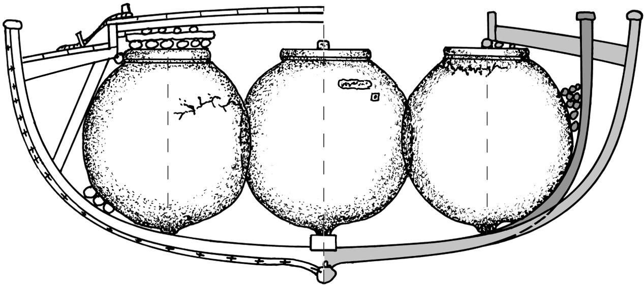
**Fig. 15 :** À droite, en gris foncé, hypothèse avec murailles droites dans le but de réduire la place perdue entre la coque et les dolia ; à gauche, hypothèse graphique, non retenue, d'un système de calage des dolia par des rondins de bois (dessin R. Roman, CCJ, CNRS, Aix-en-Provence).
