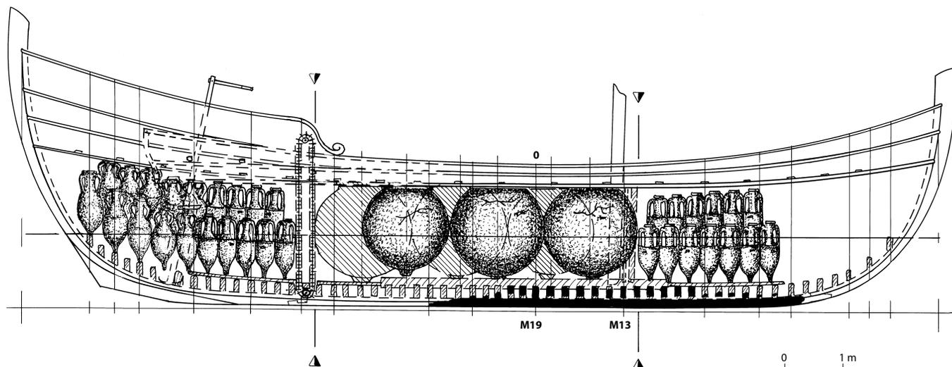
**Fig. 1 :** Vue longitudinale du navire avec la cargaison en place. Reconstitution à partir des formes extrapolées de l'épave de Cavalière (hachurées) et des vestiges conservés de l'épave de Ladispoli (en noir) (dessin R. Roman, CCJ, CNRS, Aix-en-Provence).
