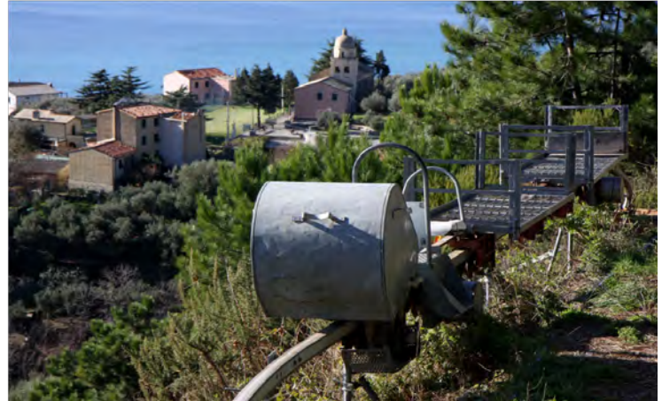
Un de ces chariots à crémaillère qui empruntent les mono-rails installés dans les années 1980 pour desservir les vignes.
