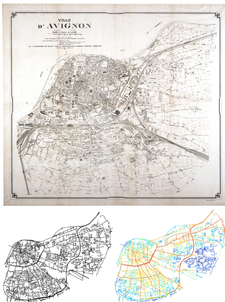
FIGURE 11 – Plan (début XX e siècle), réseau viaire brut actuel et analyse de la centralité simplex des voies de la ville d'Avignon, intra et extra-muros
