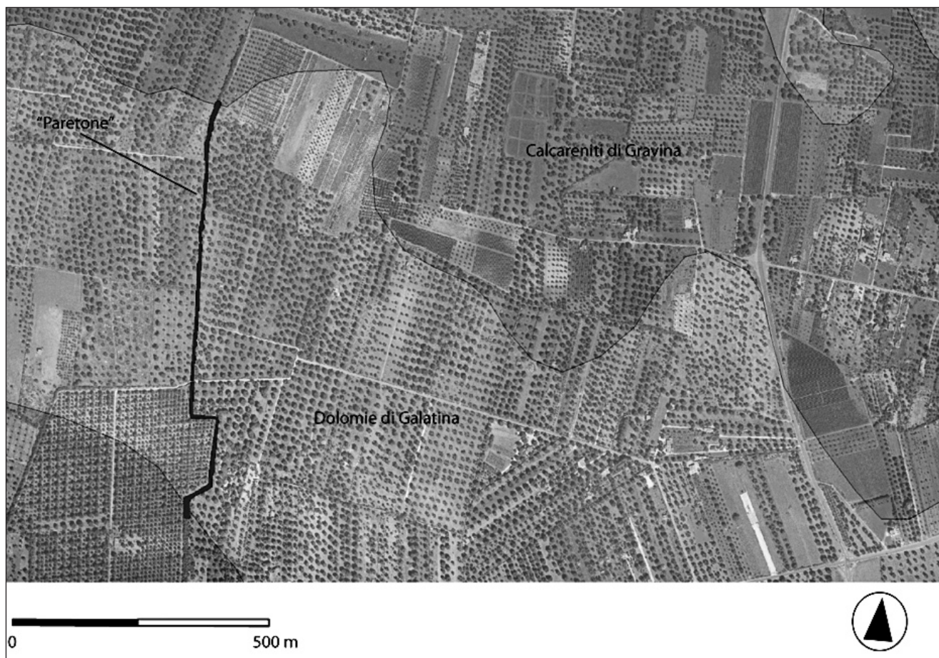
fig. 5 – Carta geologica in trasparenza su ortofoto e feature class poligonale sovrapposta al tracciato del paretone di Sava (Dati: SIT Regione Puglia – elaborazione C.N.).
