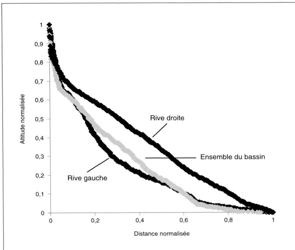
Fig. 4 – Intégrale hypsométrique du bassin de la Têt.
