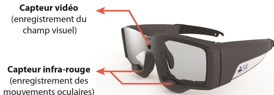
Figure 1 : Fonctionnement des lunettes eye-tracking développées par SMI et utilisées dans le cadre de l'expérimentation
