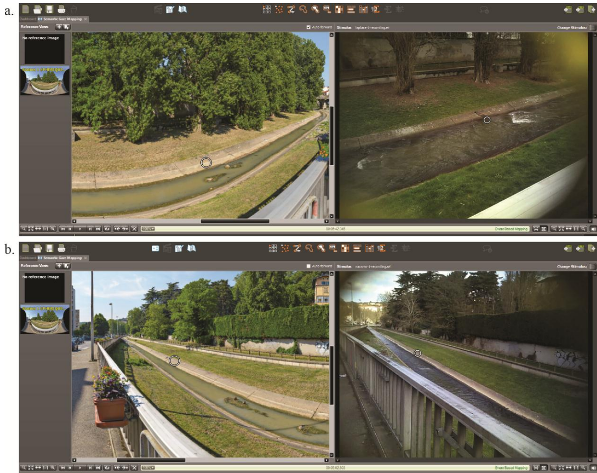
Figure 7 : Illustration des difficultés rencontrées pour la mise en œuvre du mapping : (a) liées à la dynamique environnementale ; (b) liées à la précision des images. Le cadre de droite représente l'image issue de la vidéo et le cadre de gauche, le panorama de référence ; le point de fixation est représenté par un cercle blanc.
