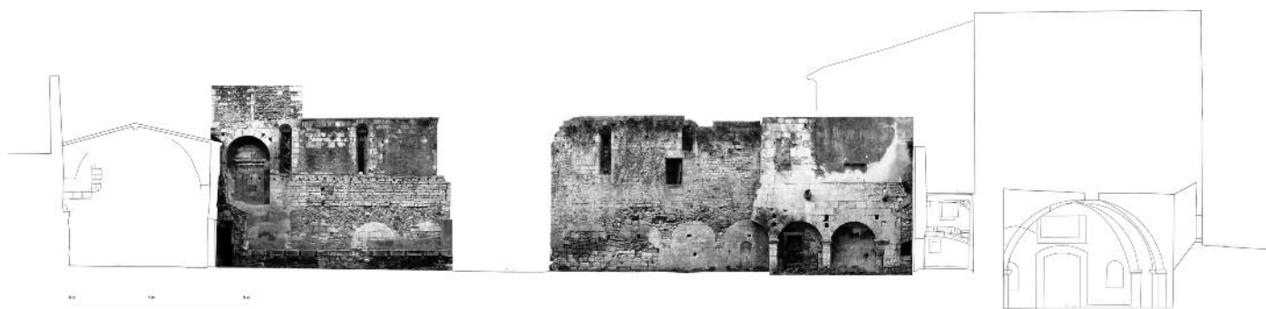
Fig.10 - Saint-Gilles-du-Gard, façade nord de l'ancien bâtiment sud du cloître (relevé tachéométrique H. Hansen, 2009-2010 et photoredressement L. Deye, H. Hansen, 2009-2011).
