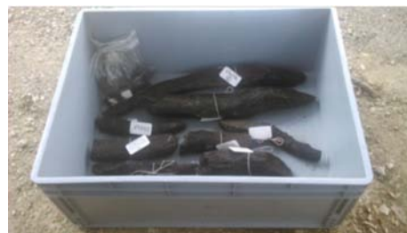
■ Fig 1. Stockage des bois gorgés de dimensions importantes dans un bac gerbable avec couvercle.
