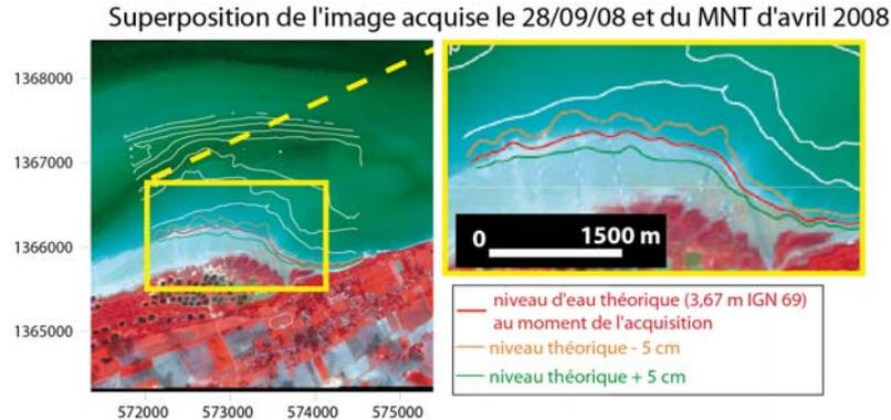
**Figure 4 :** Comparaison des isohypses du MNT de la zone générées à partir des mesures *in situ* avec l'isohypse théorique créée à l'altitude théorique du niveau d'eau atteint au moment de l'acquisition satellite. L'ensemble des informations est ici superposé sur l'extrait de l'image Formosat-2 du 28 septembre 2008 © NSPO distribution Spot Image. *Shoreline estimated by the in situ Digital Elevation Model (DEM) at the time of the Formosat-2 satellite acquisition.*
