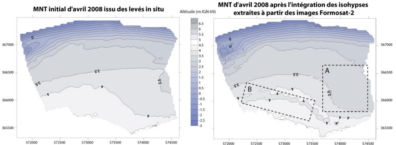
**Figure 6 :** Comparaison entre le modèle numérique de terrain initial de la zone d'étude engendré à partir des levés topographiques *in situ* et celui ré-interpolé après intégration des informations issues des images satellites. Encadrés A et B : zones de principaux changements. *Comparison between initial DEM of study area and transformed DEM after integrate extracted waterlines. Boxes A and B show the main modifications.*
