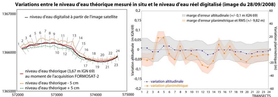
**Figure 5 :** Calculs de la variation des marges d'erreurs planimétriques et altitudinales pour chaque transect entre le niveau d'eau digitalisé (noir) et le niveau d'eau théorique estimé à partir des mesures *in situ* (rouge) lors de l'acquisition Formosat-2 du 28/09/2008. *Elevation and planimetric errors and uncertainties between the shorelines obtained by the in situ DEM (in red) and the originally extracted waterline from the satellite image, 28 September 2008 (in black).*
