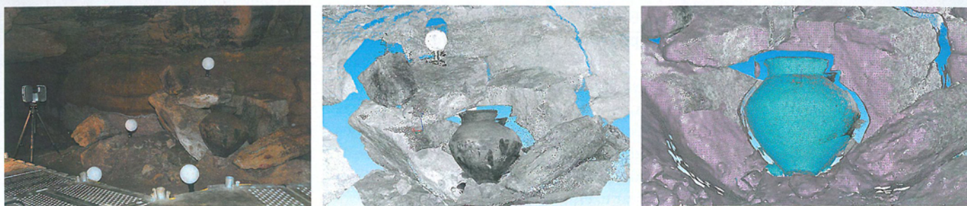
Figure 8 : Numérisation 3D d'une jarre de l'âge du Bronze à l'aide du scanner laser à différence de phase FARO Focus 3D (à gauche) et visualisation du nuage de points (au milieu et à droite). 3D-recording of a Bronze Age ceramic deposit from the cave using the FARO Focus 3D (on the left) and visualization of the deposit from the point cloud (in the middle and on the right).
