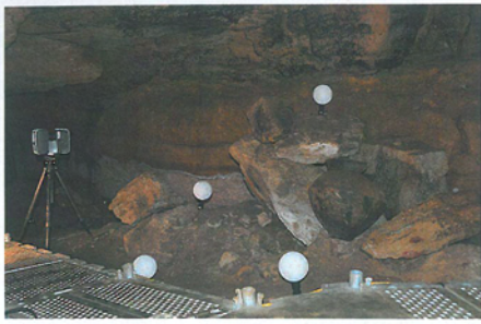
Figure 8 : Numérisation 3D d'une jarre de l'âge du Bronze à l'aide du scanner laser à différence de phase FARO Focus 3D (à gauche) et visualisation du nuage de points (au milieu et à droite). 3D-recording of a Bronze Age ceramic deposit from the cave using the FARO Focus 3D (on the left) and visualization of the deposit from the point cloud (in the middle and on the right).
