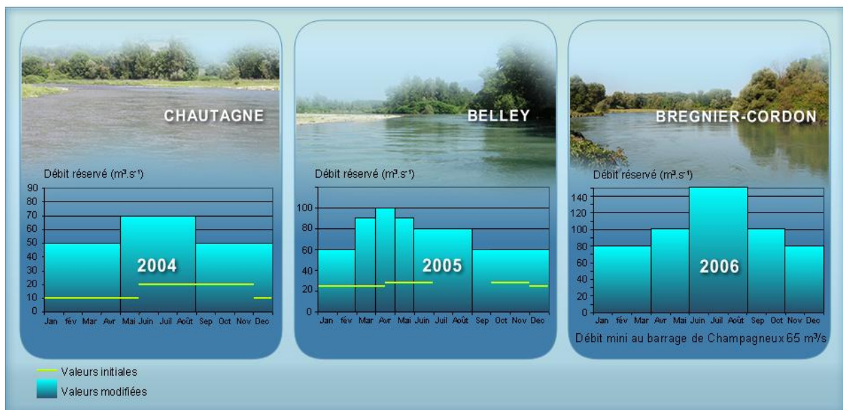
Figure 2.1.2 : valeurs minimales des débits dans les Vieux-Rhône de Chautagne, Belley et Brégner-Cordon avant et après modification des valeurs dans le cadre du programme de restauration du Rhône.
