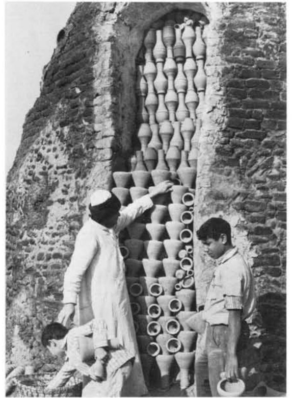
b — four n° 1 : fin du chargement dans l'ébrasement de la porte.
