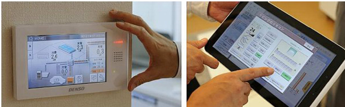
Figure 6 : Dispositifs de visualisation du HEMS et application sur tablette
