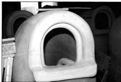
Figure 65 Creuset de verrier de la fabrique du Courval (vallée de la Bresle en Normandie) monté aux colombins dans la poterie attenante à la verrerie. Le façonnage et le séchage de ces gros pots (1,30m de H. environ pour contenir 500 Kg de verre fondu) nécessitent plusieurs mois et leur durée d'utilisation est à peu près équivalente
