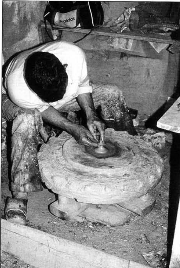
figure 19 Les outils et les gestes demeurent. Travail à la tournette crantée au Portugal en 1987
