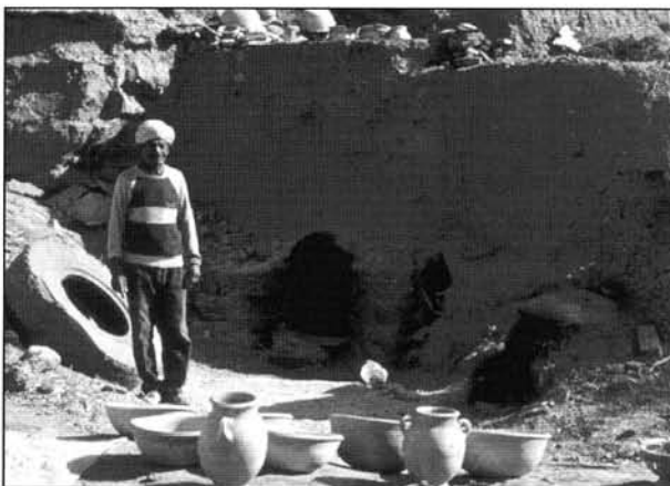
figure 116 Tout ce qui est susceptible de se consumer peut être utilisé. Ici à gauche des pneus. Atelier de la Kasbah de Taourirt à Ouarzazate, Maroc (1991)
