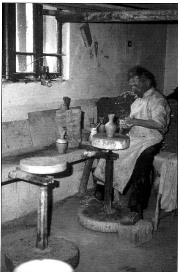
Figure 88 Atelier de tourneur à deux postes de travail sous les fenêtres. Au mur, estèques et autre petit outillage de décoration. Cristioru de Jos, Roumanie, 1992
