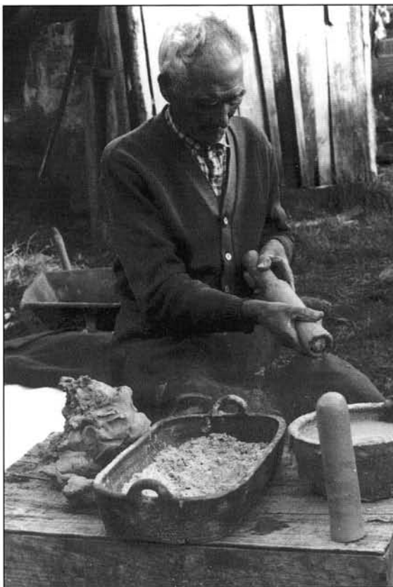
figure 120 La fabrication des pièges à taupe à Molelos, Portugal en 1992. De gauche à droite au premier plan la motte de terre, la cendre dont le moule est enduit, un récipient plein d'eau, un piège terminé. A l'arrière plan, le potier moule le piège
