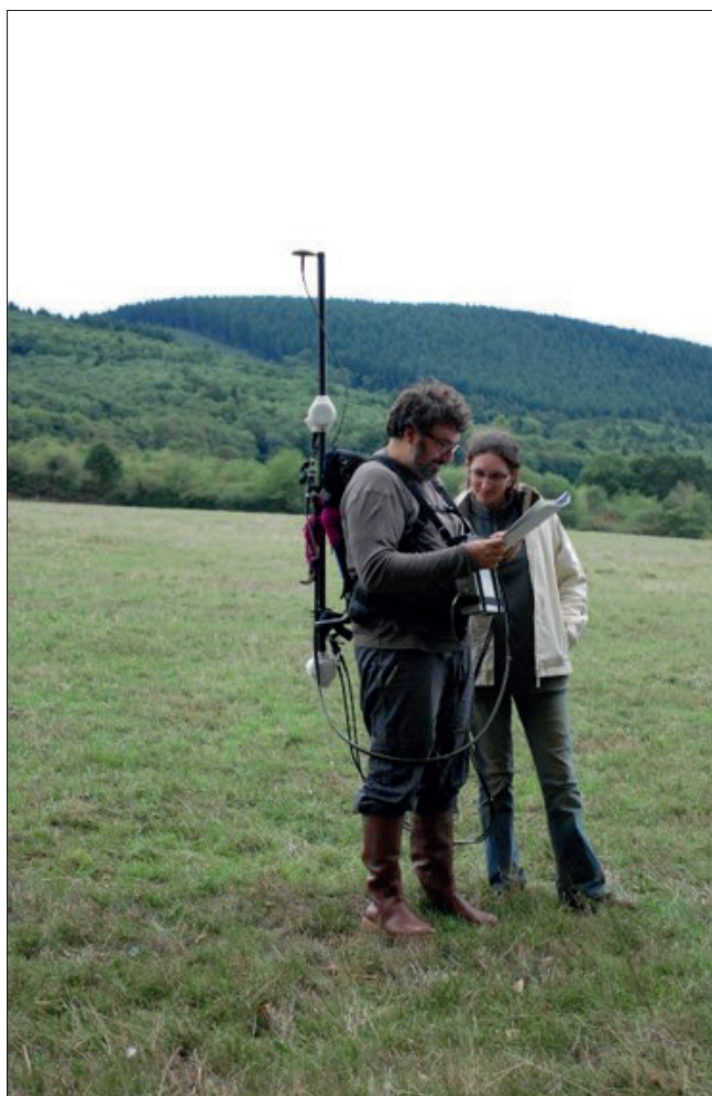
1. Étude des mines d'étain en alluvions et en roche du Sud du Morvan. Prospection géophysique sur Autun. Équipement pour la prospection sur le terrain : gradiomètre et GPS à antenne.
