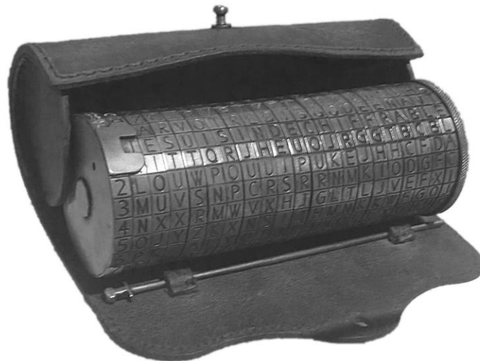
Fig. 6. Le cylindre de Bazeries. Exemple exposé au Musée des Télécommunications de Rennes. Photographie P. Guillot
