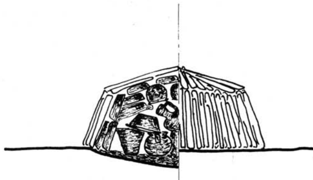
Figura 7: Desenho de uma soenga «primitiva».
