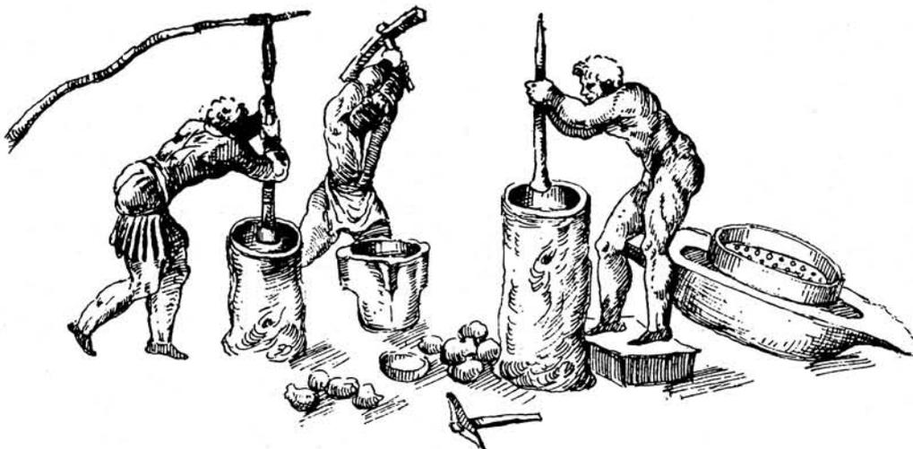
Fig. 5: De droite à gauche: auge avec tamis, pilon et mortier de bois, concassage dans un mortier de pierre et pilon à ressort, Italie, vers 1540. (Piccolpasso 1976: 140).
