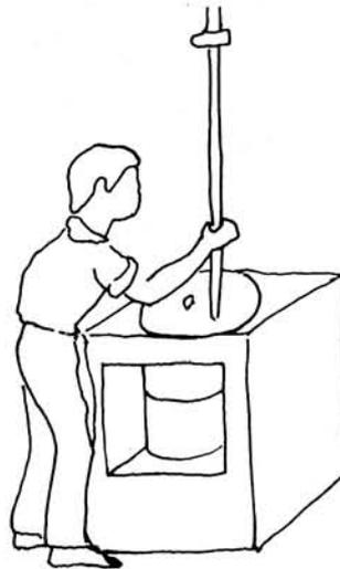
Fig. 21: Moulin à vernis en auge à barre excentrique, tournant dans un caisson à Saint-Jean-de-Fos, XXe s. (Vayssettes 1987: 138 d'après Paul Lanave).
