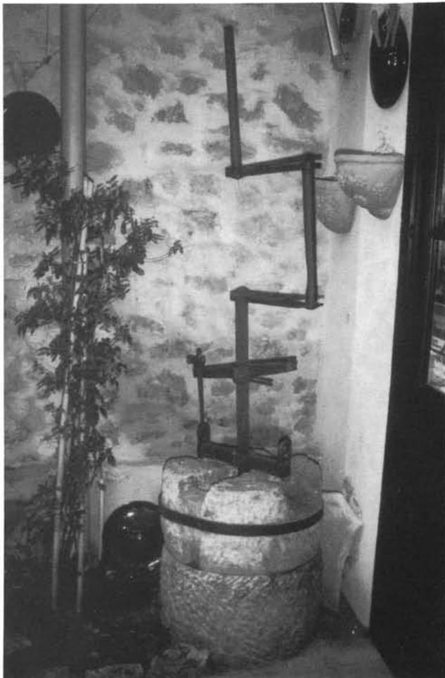
Fig. 31: Moulin à bras à vernis, composé d'une dormante en granite encaissée normalement dans un demi-tonneau et d'une tourante faite de deux portions de demi-meules assemblées de façon non-jointive par des pièces métalliques, Poterie Foucard-Jourdan à Vallauris, XIXe-XXe s. Cliché H. A.
