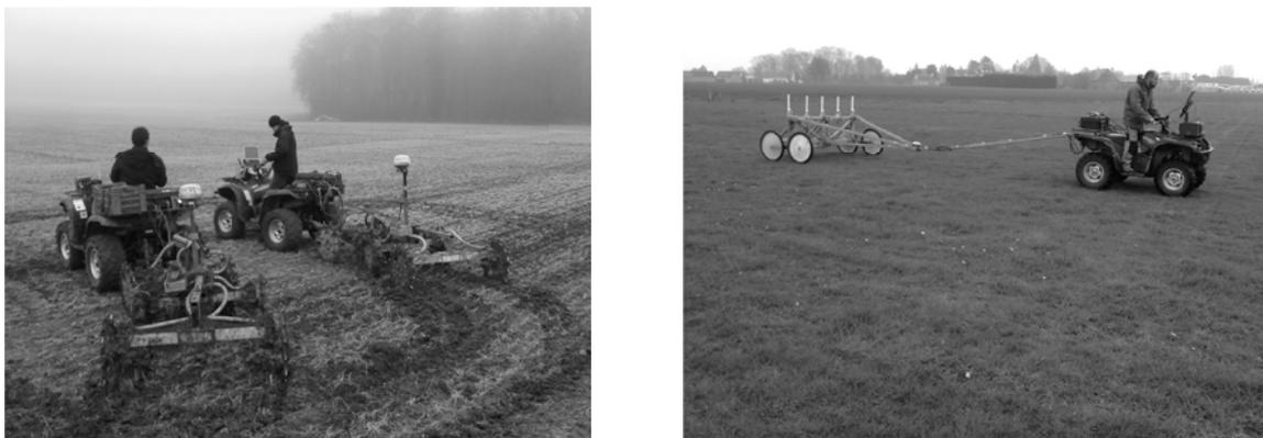
**Figure 2.** Méthode électrique automatisée ARP® (gauche) et magnétique AMP (droite)
