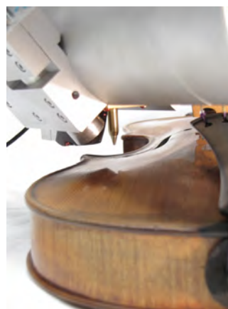
Analyse par spectrométrie de fluorescence X du vernis du « Sarasate ». L'analyse se fait sans contact, et ne modifie aucunement l'instrument.
