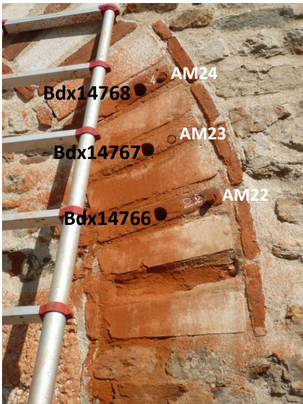
Figure 2: Les prélèvements des claveaux de l'arc d'entrée sud Bdx14766/AM22, Bdx14767/AM23 et Bdx14768/AM24 (clichés : SB)
