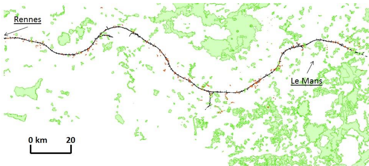
Figure 1 : carte du tracé de la LGV-Bretagne Pays de Loire avec en bleu foncé le tracé envisagé au moment du projet, en vert les sites à enjeux de biodiversité évités par le tracé et en rouge les sites de compensation (carte réalisée sur SIG par J-M.Fourès)
