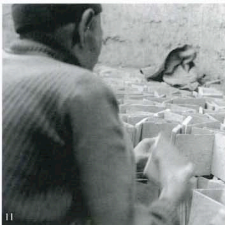
9 - Fès, smaltatura delle formelle 10 - Kutahya (Turchia), la pittura delle formelle 11 e 12 - Fès, carica di un forno a forma di castello di carte
