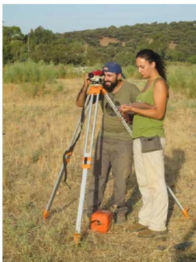
Fig. 5. Práctica de toma de datos con un nivel .
