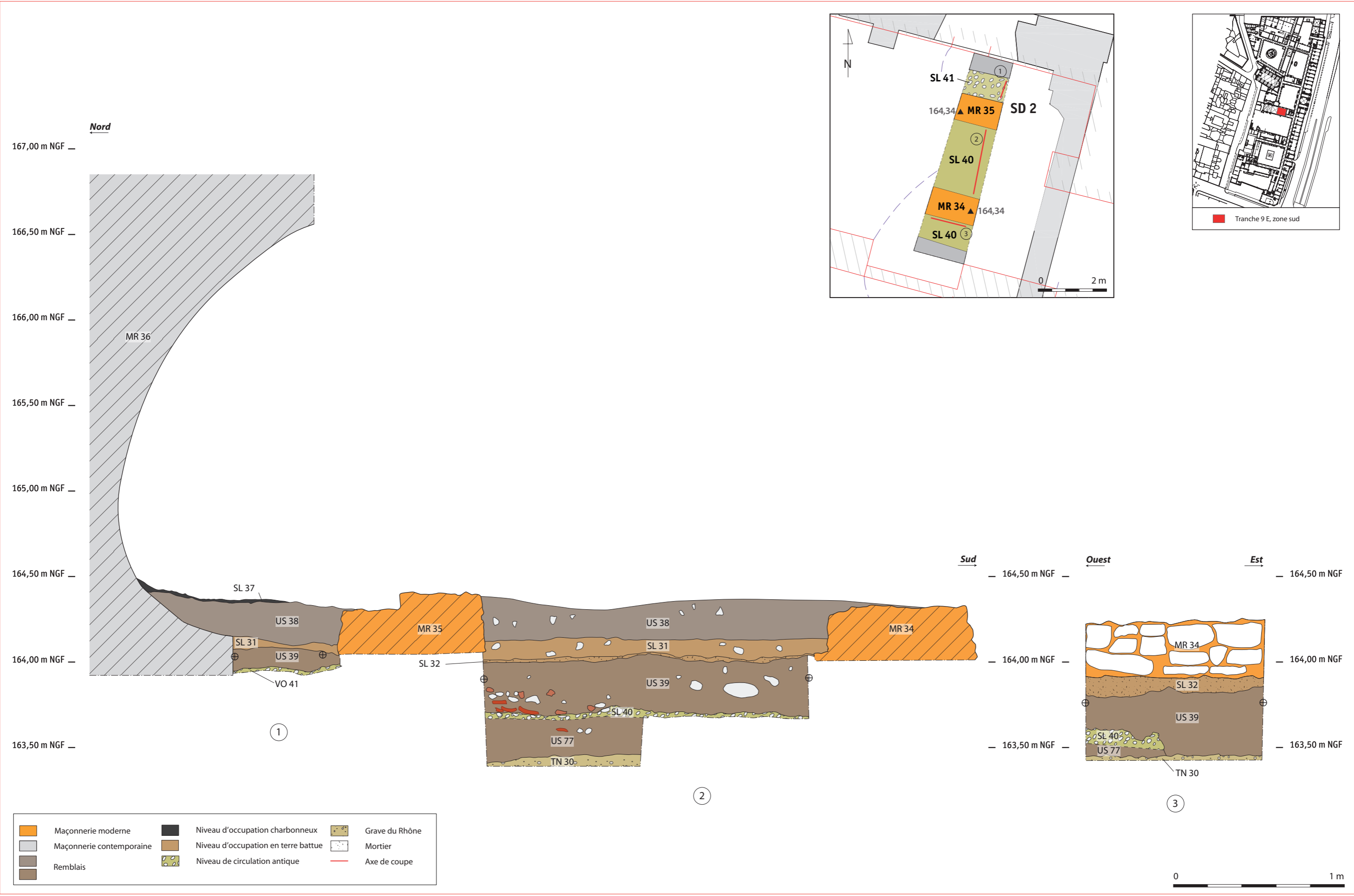
Reconversion de l'Hôtel-Dieu (69 002 Lyon) - Tranche 9 E, zone sud - 2015-2016 Sondage SD 2 dans la cave G 2 : plan des vestiges (1/100) et coupes nord-sud (1) et ouest-est (2) (1/20) Relevés de terrain : Th. Genty, O. Puel DAO : N. Hirsch, Ch. Ybard
