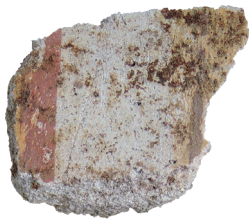
Fig. 3 : US 59, filets rouge ocre et brun (0,8 et 0,3 cm) sur fond blanc, support en mortier (M59E1F3).
