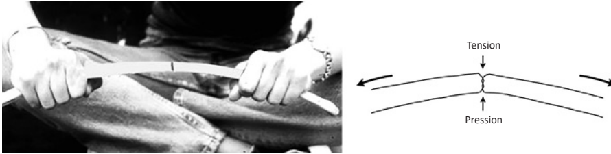
Fig. 11 : Schéma présentant un éclatement par flexion. Noëlle Provenzano. 2001, p. 273.
