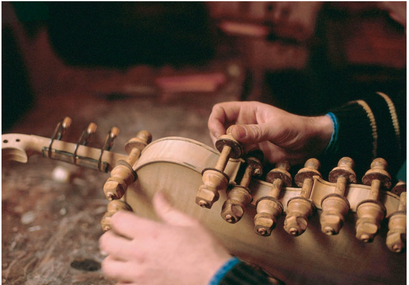
fig. 6 Marion Kalter, Assemblage de la table d'harmonie, du fond du violon et des éclisses à l'aide des presses à tabler. © akg-images/Marion Kalter.
