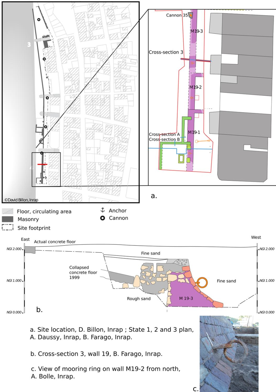
Figure 4. Seawall structure in Saint-Pierre (Martinique) (A. Bolle).
