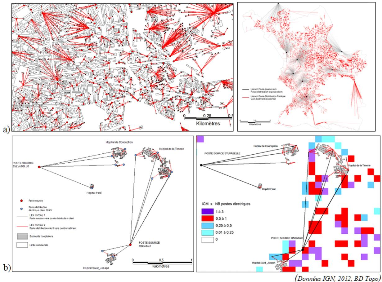
**Figure 8 a : Raccordement des nœuds du réseau électrique de distribution publique aux centroïdes des bâtiments résidentiels de la commune de Marseille. b : Croisement susceptibilité (partie 1) avec alimentation électrique des hôpitaux (Données IGN, 2012, BD Topo)**
