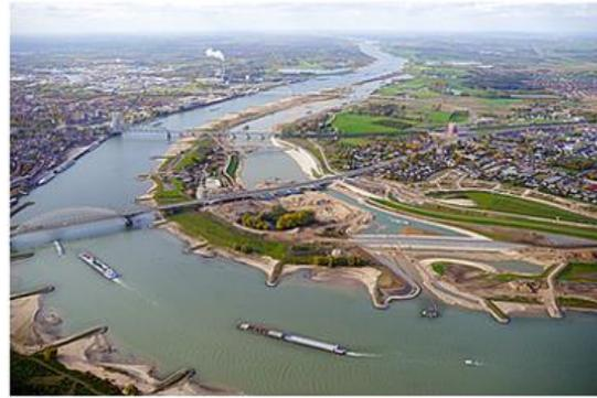
Nijmegen « après » : le projet RVR « de l'espace pour la rivière » a intégré la démolition, le recul et la reconstruction de la digue, le creusement du nouveau bras de rivière et sa presqu'île, la construction de ponts, de passerelles et d'un barrage. L'ensemble compose un nouveau paysage fluvial.
