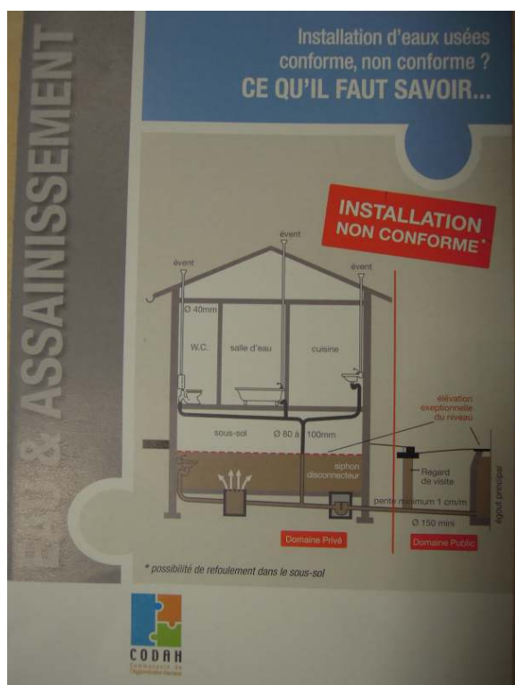
Figure 9 : Exemple d'une installation non conforme pouvant entraîner un blocage de permis de construire - Préconisations du PLU relatives au risque d'inondation
