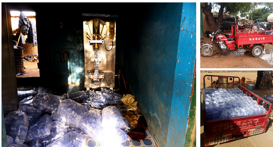
4. Machine de conditionnement d'eau en sachet et véhicule de distribution à Niamey (Niger) (Younsa Harouna, 2017)
