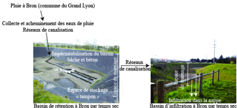
Figure 2. Les dispositifs techniques des systèmes centralisés : un cycle hydrosocial fondé sur des réseaux, des bassins, la décantation et l'infiltration
