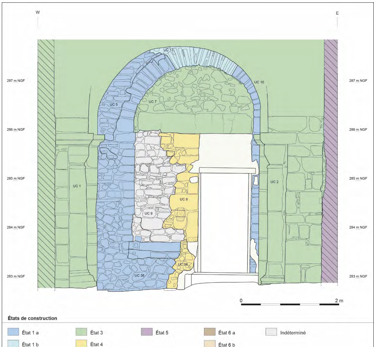
Fig. 2. Savigny (69) : chapelle Saint-Léger : mur nord, parement nord. Phasage de la construction (1/40). C. Besse, A. Devillechaise, L. Eneau-Brun, O. Puel, B. Solard.
