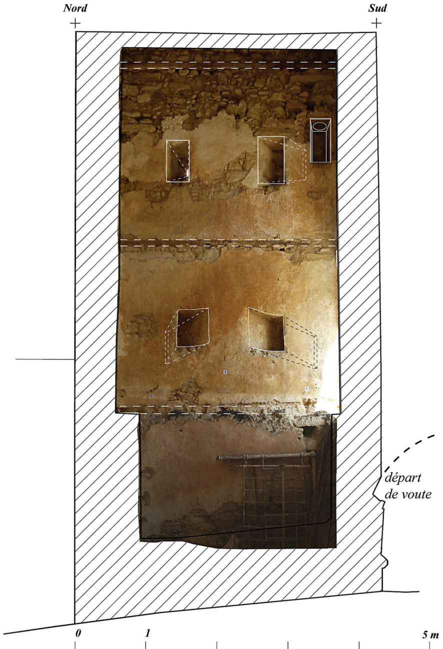
Fig. 7 - Maison-tour : élévation intérieure mur est et coupe transversale intérieure (Relevés H. Hansen, DAO E. Maglio 2014)
