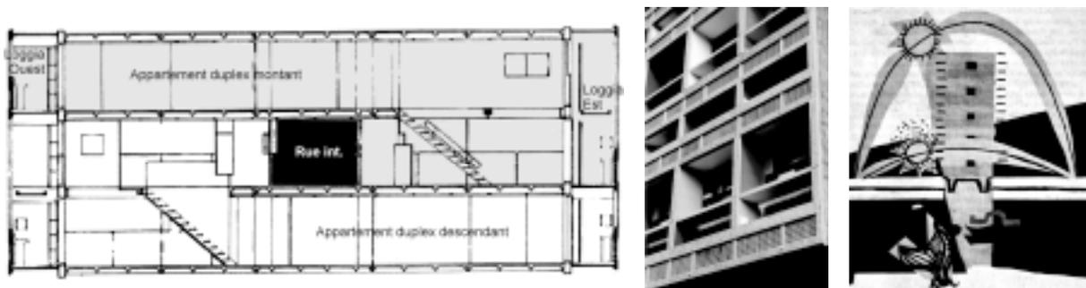
Figure 1: A gauche : coupe sur les appartements types, duplex traversants orientés Est-Ouest. Au milieu : les loggias de l'Unité d'Habitation de Rezé-Lès-Nantes, dite « Maison Radieuse ». A droite : le « diagramme solaire » de l'Unité d'Habitation selon Le Corbusier.
