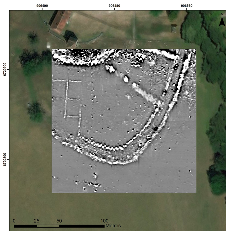
Fig. 9 – Seveux, « Pré Bouché », résultats de la prospection magnétique [-20/20 NT] sur fond aérien [BD ORTHO, IGNF]
