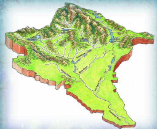
La simulation de l'écoulement d'un fluide (plus ou moins visqueux) permet de mieux appréhender des notions comme celle de **bassin versant** (ensemble de la surface recevant les eaux qui circulent naturellement vers un même cours d'eau ou vers une même nappe).
