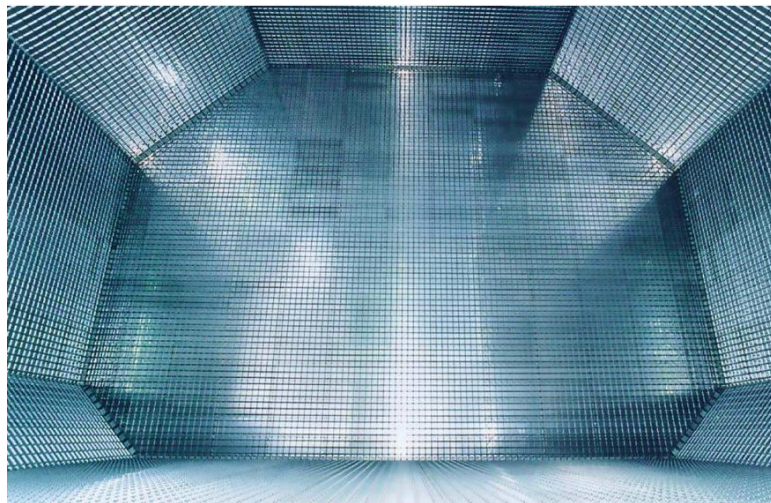
Figure 3. Les technologies à membranes sont directement posées sur la coque interne du navire (Photo DNV GL, 2015)
