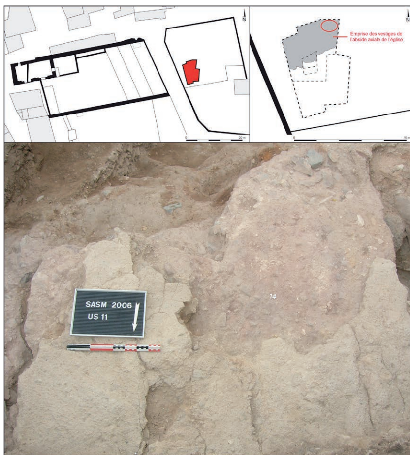
Fig. 31 Emprise du chevet, sondage d'évaluation : vue générale du sol le plus récent avec les empreintes de dalles sur le radier (US 11) (cl. Olivia Puel, 2006).
