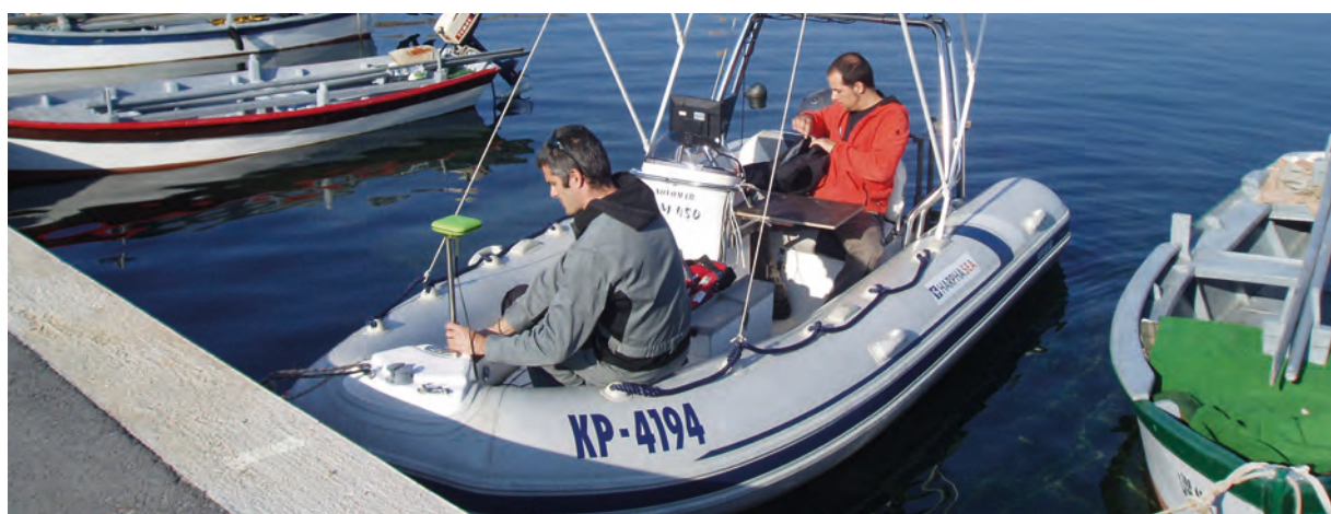
I.37 Izrada batimetrijske snimke u 2012. godini, plovilo s multibeam uređajem The bathymetric survey in 2012, boat with multibeam sounder (fotografija / photo by: I. Koncani Uhač)
