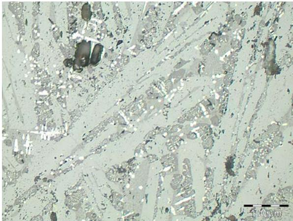
Fig. 2 : Métallographie d'un culot de forge : matrice vitreuse avec des lattes de fayalite ( $\text{Fe}_2\text{SiO}_4$ ) et des dendrites de wüstite ( $\text{FeO}$ )
