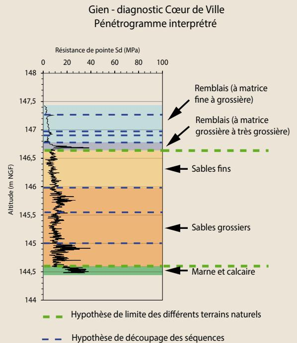
Fig. 3 : Diagramme interprété d'un sondage réalisé au PANDA®
