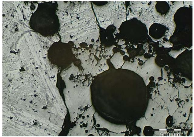
Fig. 3 : Métallographie d'un culot de forge : matrice siliceuse
