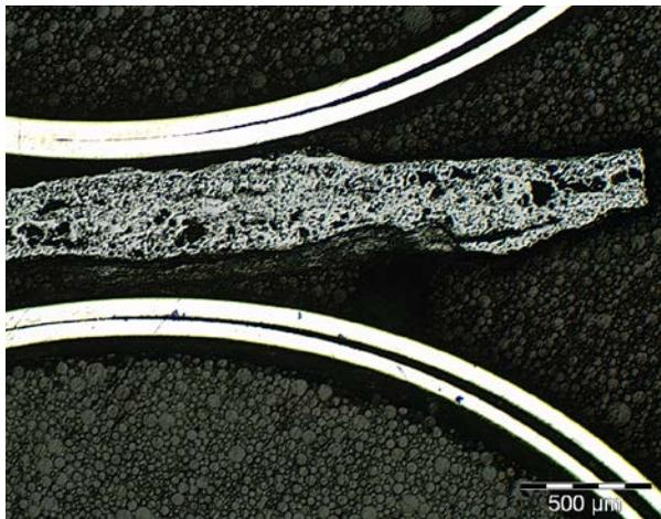
Fig. 4 : Métallographie d'une battiture lamellaire : magnétite massive ( $\text{Fe}_3\text{O}_4$ ) avec liseré d'hématite ( $\text{Fe}_2\text{O}_3$ ) ou de magnétite massive
