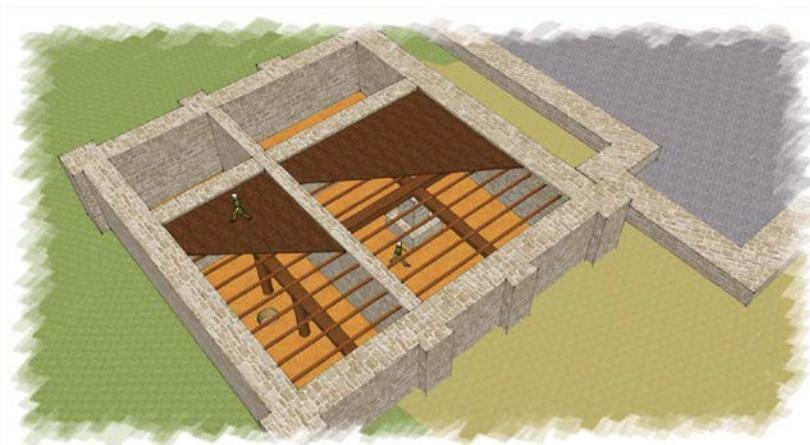
Fig. 3 : Un de ces cloisonnements nord-sud est remplacé à la fin du X<sup>e</sup> siècle, début du XI<sup>e</sup> siècle par un mur en maçonnerie de pierre lié au mortier perpendiculaire au mur de refend et partitionnant dès lors le bâtiment en quatre sous-espaces, par Magali Labille © Logiciel Sketchup Make 2017, Département du Loiret - SAP.
