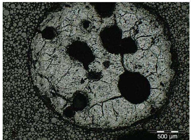
Fig. 5 : Métallographie d'une battiture globulaire : fayalite en lattes ( $\text{Fe}_2\text{SiO}_4$ )
