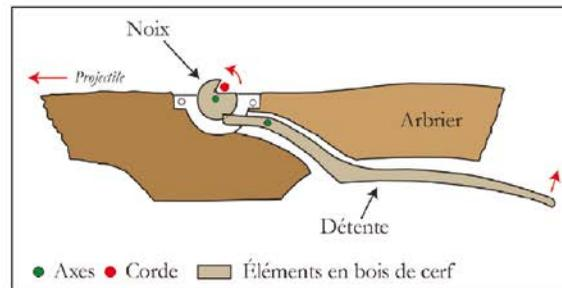
Fig. 2 : Fragment de détente d'arbalète en matière dure animale © Yannick Mazeau. Mécanisme d'une arbalète des X<sup>e</sup>-XII<sup>e</sup> siècles : fig. 1 p. 2 dans GORET J.-F., « Les détonnes d'arbalètes en bois de cerf entre le X<sup>e</sup> siècle et le XII<sup>e</sup> siècle en France », *Cahiers LandArc*, 20, 2017.
