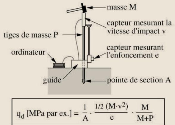
Fig. 1 : Schéma fonctionnel du pénétromètre à résistivité PANDA®
