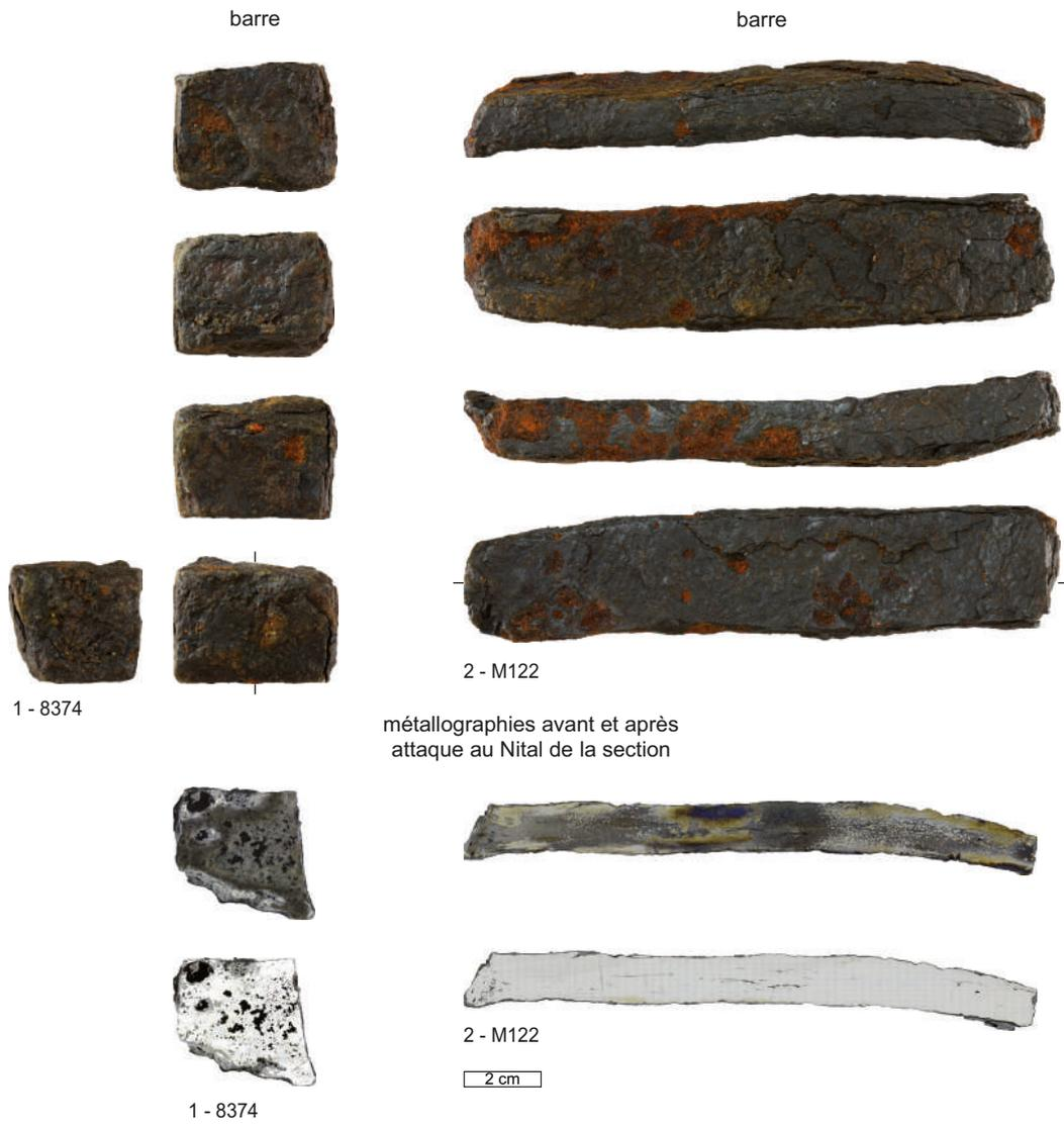
Pl. 61 : Strebersdorf. Macrographies et métallographies avant et après attaque au Nital de la section.
