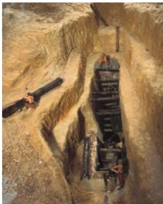
galeries d'exhaure ouvertes à mi-profondeur des travaux. Les galeries d'exhaure étaient ouvertes dès le début des travaux et pouvaient n'avoir que peu servi, comme à la mine de la Fagassière (Château-Chervix, Haute-Vienne).
