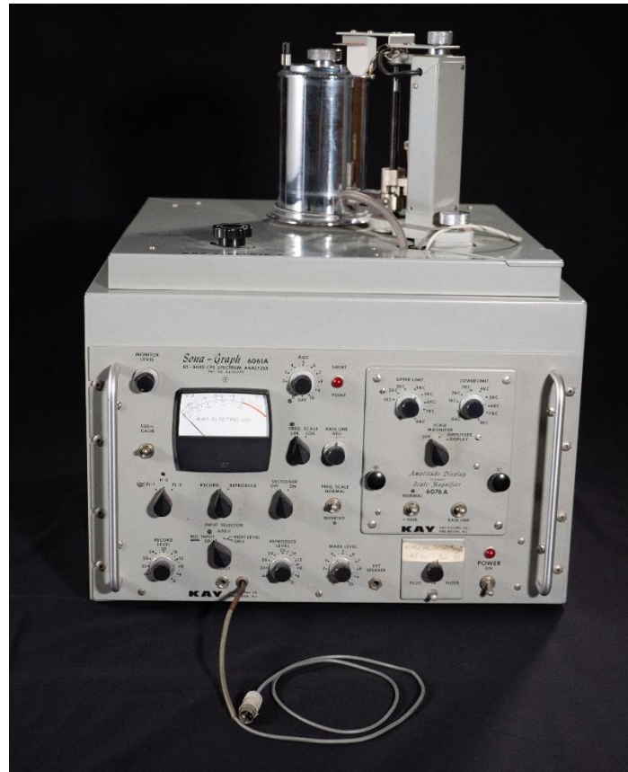
Figure 6. Vue du sonographe présent au laboratoire Praxiling (ITIC, Université Paul-Valéry Montpellier 3) datant de 1970.
