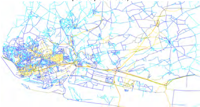
Figure 13. Calcul de marches aléatoires sur le réseau routier extrait du SIG de la ville du Havre. La couleur des arêtes indiquant le taux d'utilisation (du bleu foncé pour les moins utilisées au rouge pour les plus utilisées)
