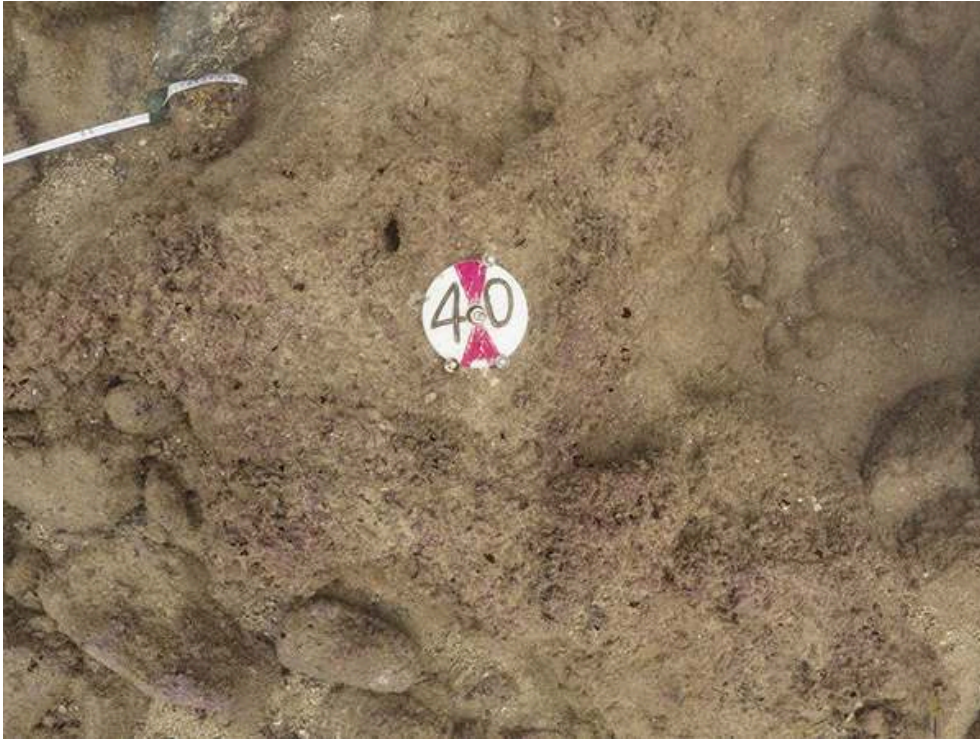
Fig. 104. Site du Phare. Photo d'un point d'appui (GCP) implanté en 2020 (P. Soubias).
