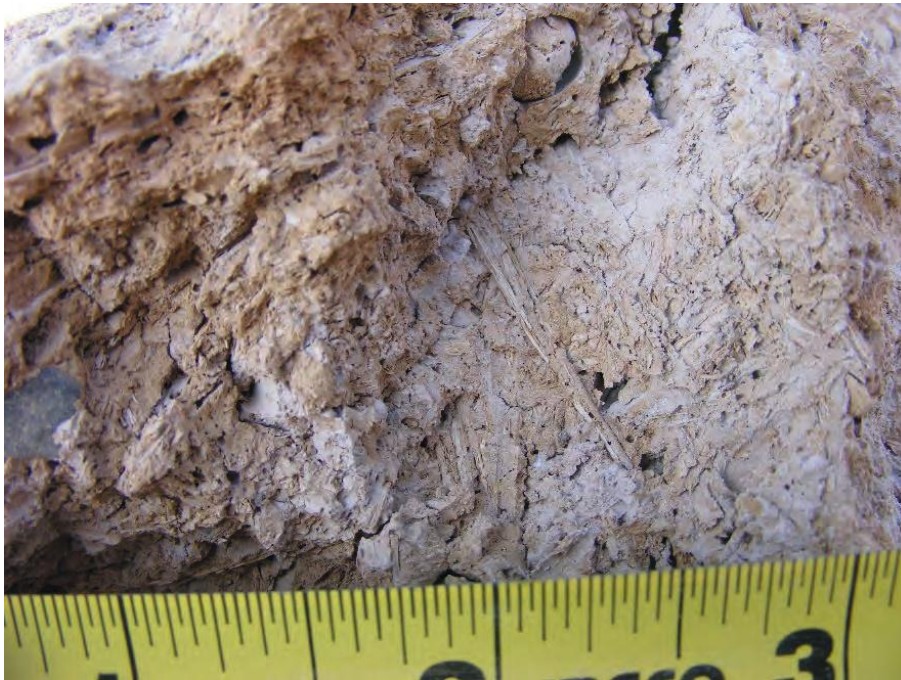
Fig. 72. Motte de terre crue riches en empreintes végétales et en pores qui pourraient correspondre à des ajouts végétaux (Mission archéologique française du Peramagron).
