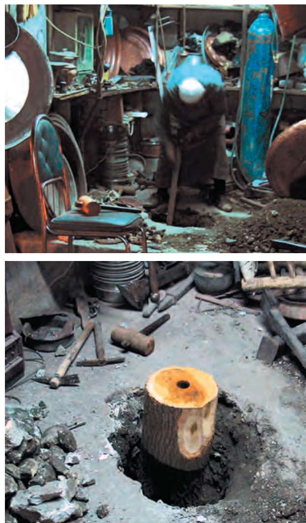
Fig. 5 - Aménagement de la fosse pour le billot d'enclume dans le souk des fondeurs d'Alep (CHANESAZ et al. , 2018 : 21, 22, fig. 7 et 8)
